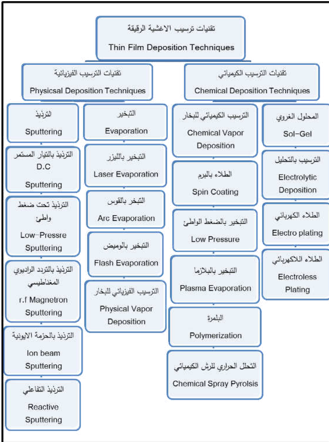
الشكل (1-1) مخطط لبعض تقنيات تحضير الأغشية الرقيقة [10].
